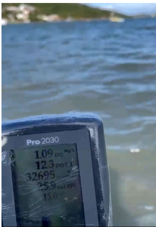
Figura 5. Imagens da equipe do Ecoando/UFSC, em 03/07/2025, na região onde está sendo depositado o material dragagem. Detalhe para a pluma de sedimento, o registro de condição de zona morta e a morte do banco de gramas marinhas.
